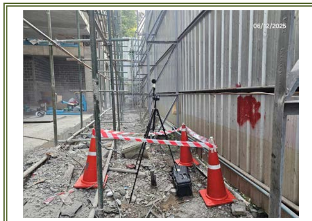
รูปที่ 3-16 การตรวจวัดความสั่นสะเทือน บริเวณพื้นที่โครงการ
