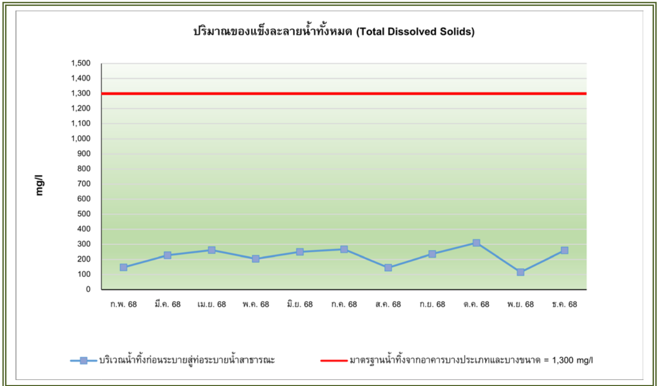
รูปที่ 3-22 กราฟเปรียบเทียบผลการตรวจวิเคราะห์ปริมาณสารที่ละลายน้ำทั้งหมด (Total Dissolved Solids) ระหว่างเดือนกุมภาพันธ์-ธันวาคม พ.ศ. 2568
